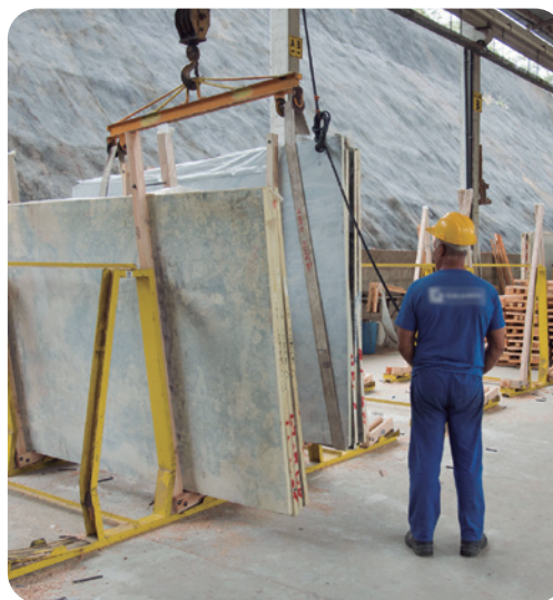
Galpão de pedras naturais cortadas e polidas sendo preparadas para embarque, Cachoeiro de Itapemirim, Espírito Santo, 2019.
